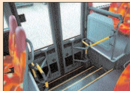
**EINSTIEG** Der hintere Einstieg überzeugt durch seine Breite und flache Trittstufen
