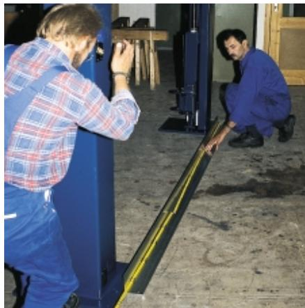
Anschließend richten die Spezialisten von Stahlgruber die Säulen der Bühne optimal aus
