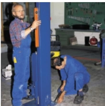
Vor dem endgültigen Verdübeln der Bühne wird mit der Wasserwaage exakt justiert
