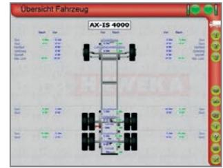
Software-Übersicht: Einzelmessungen werden für jede Achse angezeigt, so ist zwischen Eingangs- und Ausgangsmessung ein Wertevergleich möglich.
