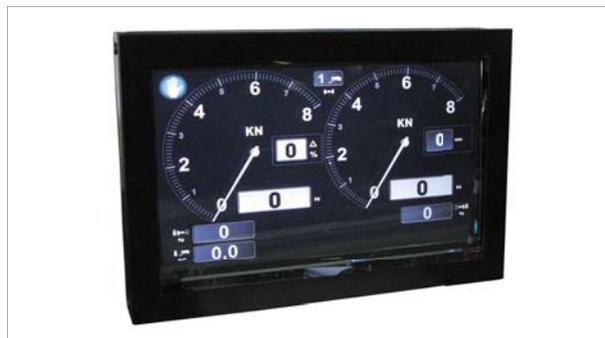
Für die Aufstellung des Prüfstandes im Freien gibt es ein optionales Outdoor-Kit für die Analoganzeige. In Verbindung mit optionaler Heizung, Wandbefestigung oder Standsäule lässt sich die Analoganzeige somit den Bedingungen vor Ort anpassen.
