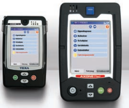
Der Axone Palm (links) ist deutlich kompakter als der Axone Pad, bietet aber die gleiche Auflösung
