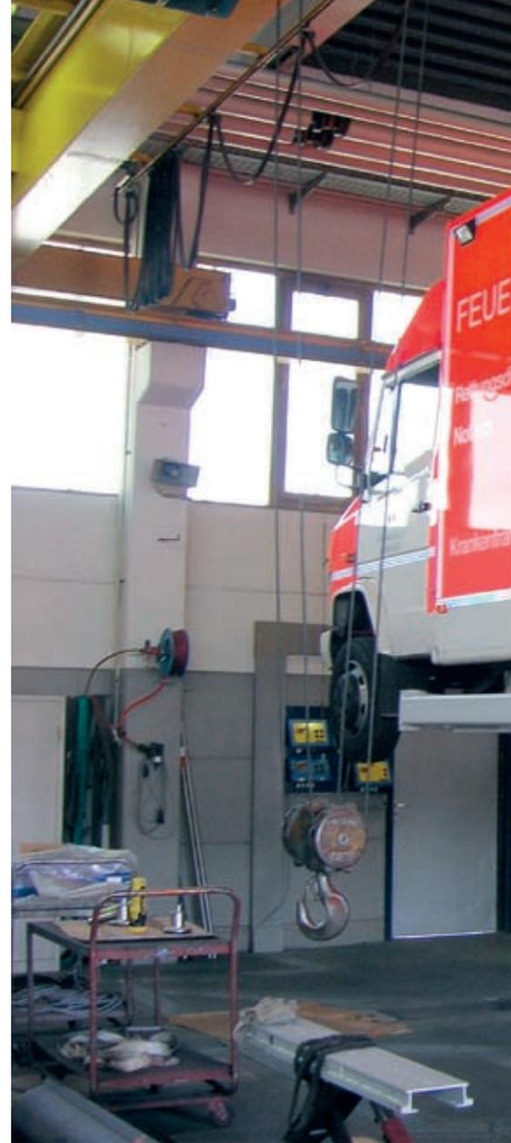
sind jeweils dreifach teleskopierbar und damit flexibel einsetzbar. Selbst ein Smart lässt sich sicher aufnehmen, wie im Rahmen einer Versuchsreihe festgestellt wurde. Ideal ist der Biglift außerdem für die Aufnahme von Sonderfahrzeugen mit komplexen Aufbauten geeignet. Das oben abgebildete Feuerwehrfahrzeug verfügt rundum über eine für Nutzfahrzeuge ungewöhnlich tief gezogene Schürze.
