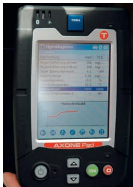
Bei Bedarf können die neuen Axone-Geräte, hier im Bild der Pad, ausgelesene Daten grafisch anzeigen
