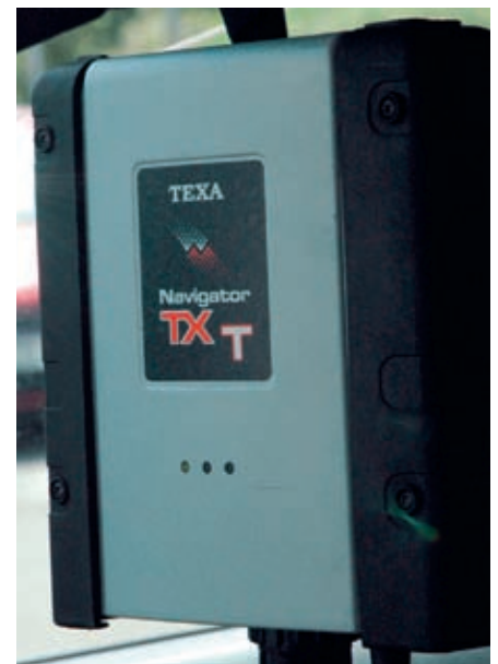
Der Navigator TXT dient als schnelles Interface zur Diagnoseschnittstelle eines Fahrzeugs
