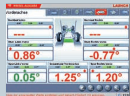
Nach der Vermessung müssen die Werte wie hier an der Vorderachse eingestellt werden
