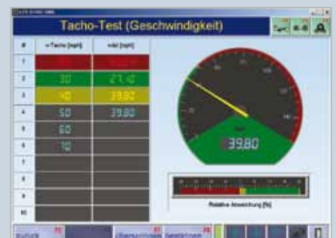
Überprüfung der Anzeige des Fahrzeugtachometers.
