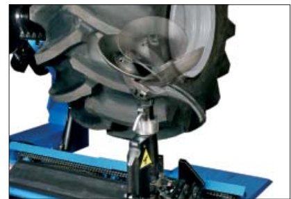
Das Montagewerkzeug ist um 180° drehbar, unabhängig von der Positionierung des Schwenkarms.
