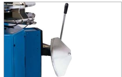
Die Abdrückschaufel ist so geformt, dass das Abdrücken einfach und felgenschonend durchgeführt werden kann.
