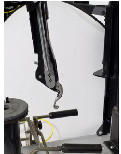
Der zu montierende Reifen wird durch einen „Montagefinger“ am Montagekopf über das Felgenhorn gehoben, der Einsatz eines Montiereisens erübrigt sich somit.
