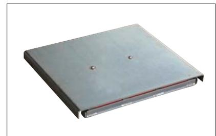
Mit dem Schnellspurtester kann sofort die Spurabweichung des zu testenden Fahrzeugs gemessen werden. Es erfordert keinen zusätzlichen Prüfaufwand, da die Prüfplatte direkt vor dem Fahrwerktester platziert und einfach überrollt wird. Die Diagnose der Vor- und Nachspur erfolgt über die automatische Messwerterfassung. Der Messwert wird in  $0 \pm 20$  mm/m angezeigt.
