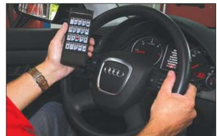
Mit der IR-Fernbedienung können die Prüfgeräte vom Fahrzeug aus bedient werden, dabei kann je nach Bedürfnis, z.B. nur der Bremsprüfstand gestartet und die Prüfreihefolge beliebig vorgenommen werden.
