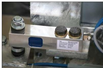
Die Erfassung der zu ermittelnden Prüfwerte erfolgt über das bewährte DMS-Messprinzip. Diese verschleißfreie Messsensorik ermittelt zuverlässig und fehlerfrei die entstehenden Kräfte
