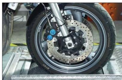
Die Pkw-Bremsprüfstände und Prüfstraßen lassen sich einfach für die Motorrad-Prüfung aufrüsten.
