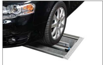
Durch das Anheben der Hebeschwelle kann das Fahrzeug ebenerdig in den Prüfstand ein- und ausgefahren werden. Bei Fahrzeugen mit Sportfahrwerk, geringer Bodenfreiheit und kleinen Raddurchmesser besteht keine Gefahr von Beschädigung am Unterboden.
