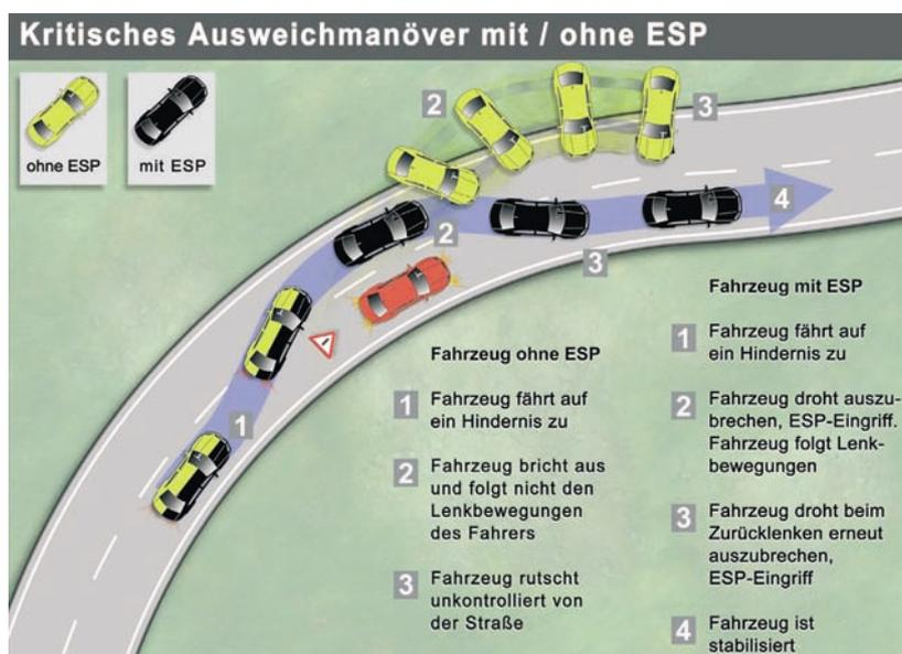
**ESP® stabilisiert das Fahrzeug, noch bevor die Situation kritisch wird**
