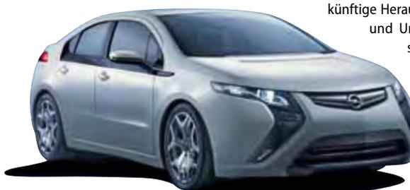
Mit der Serienversion des Elektroautos **Ampera** bietet Opel aus eigener Sicht „die Innovation, die die Autoindustrie braucht, um für heutige und zukünftige Herausforderungen im Energie- und Umweltbereich gerüstet zu sein.“ Auf längeren Strecken wird der Elektromotor von einem kleinen Verbrennungsmotor als Generator mit Strom gespeist, was eine größere Reichweite ermöglicht.
