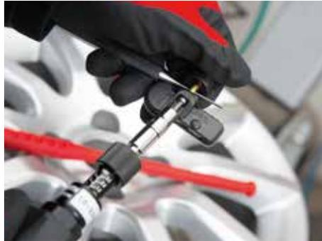
Fixierung Gummiventil am Reifendruck-Kontrollsensor mit 1,4 Nm
