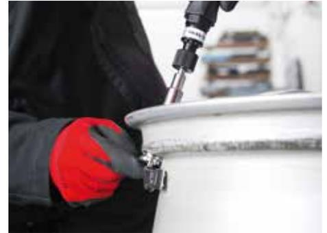
Anziehen der Überwurfmutter des Reifendruck-Kontrollensors mit 8,0 Nm
