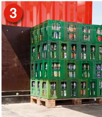
3 Ladung: Palettierte Getränkekästen immer bündig an die Stirnwand laden. Halten Sie stets den Lastverteilungsplan ein.
