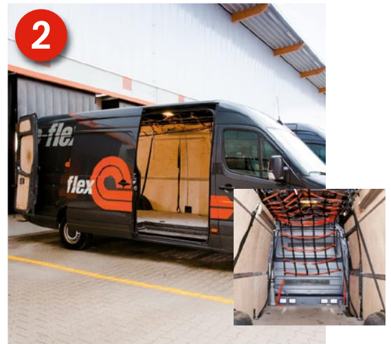
2 Wichtig: Der Laderaum ist vom Fahrerhaus durch Rückhalteeinrichtungen oder Trennwände abgeteilt (kleines Bild). Eine besenreine Ladefläche ist Pflicht!
