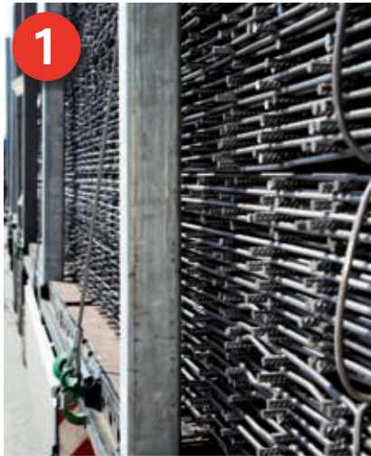
1 Lasi-Hilfe: Auf einem speziellen Fahrzeug können Betonstahlmatten in alle Richtungen formschlüssig z. B. durch Steckungen gesichert werden.
