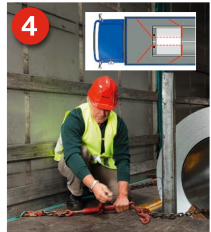
4 Legen Sie die Zurrmittel an (siehe Grafik) und sichern Sie damit das Coil gegen Rutschen nach hinten und das seitliche Herausrollen.
