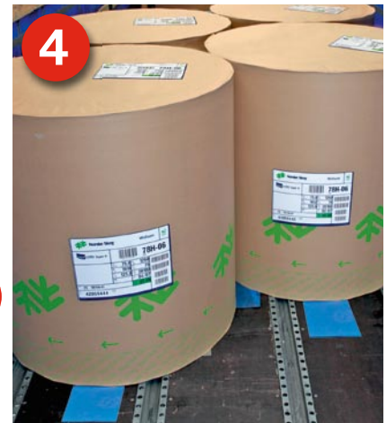
4 Stellen Sie die Rollen symmetrisch zur Fahrzeuglängsachse auf. Dabei sollten Sie darauf achten, dass sich die Rollen untereinander berühren.
