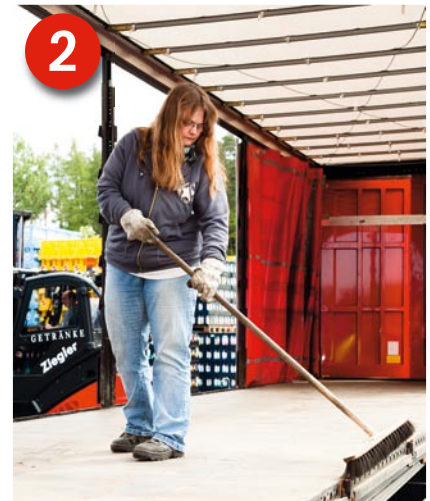
2 Voraussetzung: Sie müssen über ein geeignetes Fahrzeug (DIN EN 12642 Code XL für Getränke) verfügen und die Ladefläche besenrein säubern.
