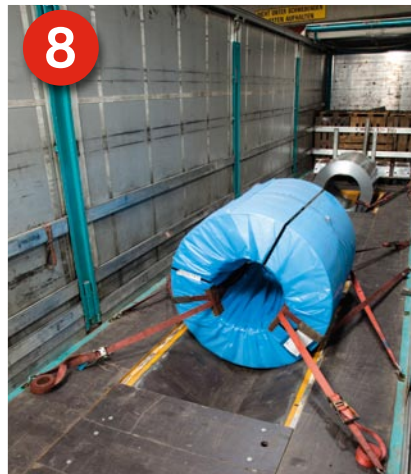
8 Fertig für die Tour: Die beiden Stahlcoils wurden ausreichend gesichert. Das Fahrzeug ist damit abfahrbereit.
