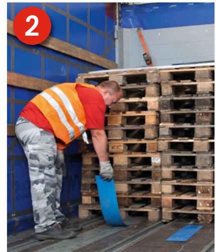
2 Richtiger Abstand: Um den Lastverteilungsplan einhalten zu können, wurden Leerpaletten als Abstandhalter an der Stirnwand aufgestapelt.
