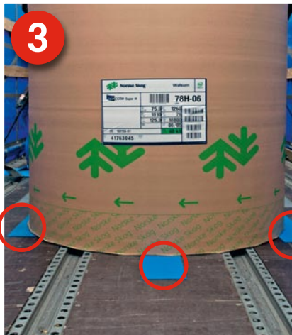
3 Antirutschmatten an die Rollenränder und zwischen die Lochschienen legen. Diese müssen mindestens 1 Zentimeter hervorstehen.
