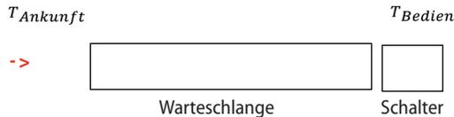
Auslastung des Schalters  $a = \frac{T_{Bedien}}{T_{Ankunft}}$
