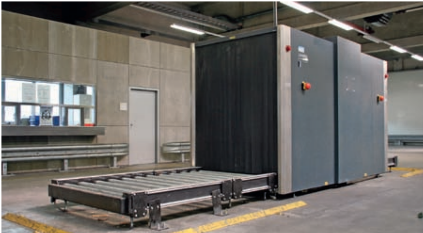
Röntgenapparat für Luftfracht-Sendungen am Flughafen Wien. Nicht alles kann entdeckt werden
