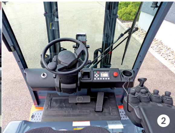
Genug Platz für die Füße. Unterseite des Armaturenrägers ist unverkleidet (1). Sachlicher Fahrerarbeitsplatz mit Minihebeln für die Mastfunktionen (2). Klein aber funktional: Display und Schalter für die Sekundärfunktionen (3). Da rappelt nichts: Die Holperstrecke steckt der in Italien gebaute Japaner ohne Probleme weg (4). Einstieg könnte bequemer sein: Etwas hohe und leicht schräge Trittstufe (5).
