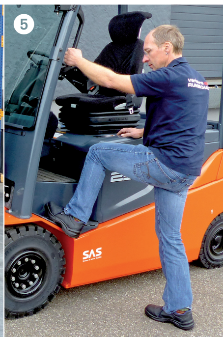
Genug Platz für die Füße. Unterseite des Armaturenrägers ist unverkleidet (1). Sachlicher Fahrerarbeitsplatz mit Minihebeln für die Mastfunktionen (2). Klein aber funktional: Display und Schalter für die Sekundärfunktionen (3). Da rappelt nichts: Die Holperstrecke steckt der in Italien gebaute Japaner ohne Probleme weg (4). Einstieg könnte bequemer sein: Etwas hohe und leicht schräge Trittstufe (5).
