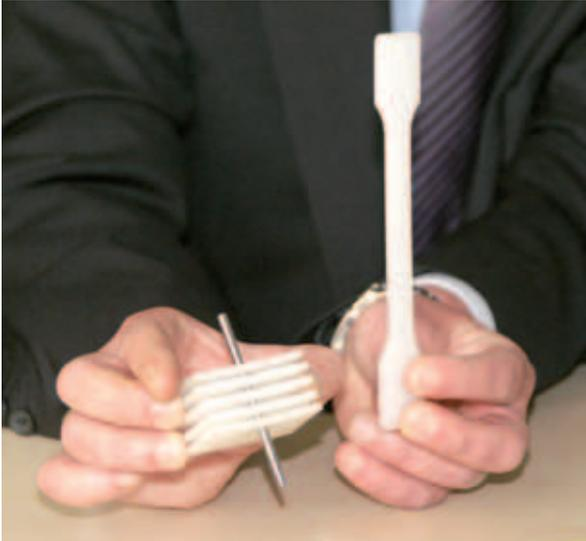
Im Vergleich: der alte Probekörper mit Metallstift (li.) und der neue, leichter herzustellende Schulterstab.
