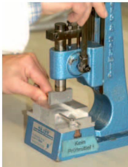
Der neue Probekörper wird vor dem Test maßgenau eingekerbt.
