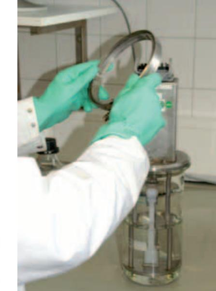
Der Probekörper im Behälter mit Prüffüllgut.
