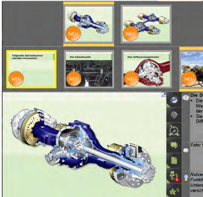
Zur Darstellung sind mehrfach Schnittzeichnungen enthalten, mit deren Hilfe auch innere Funktionen der Bauteile bestens erläutert werden können.
