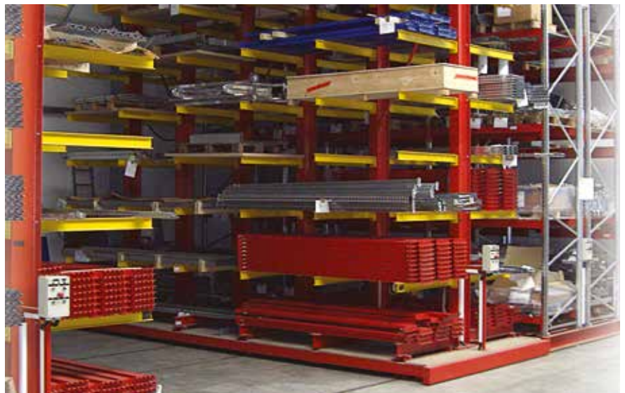
Lagerung von Langgut im Schwerlastbereich
