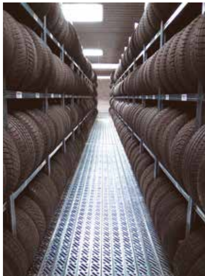
Mehrgeschossig stehende Räderlagerung im Regalverbund.
