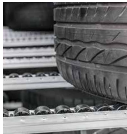
Auf Röllchenleisten gleiten die Räder dem Bediener entgegen
