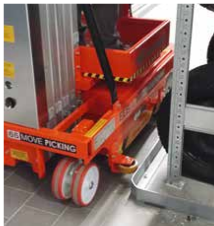
Führungsrollen für sichere Zwangsführung.
