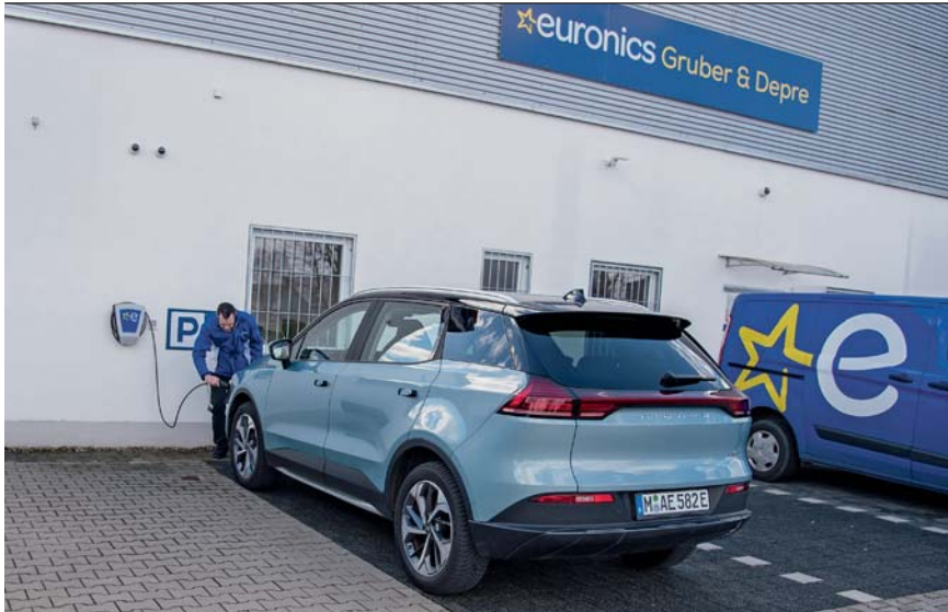
Der Ladeanschluss befindet sich unter dem linken Scheinwerfer. Knapp vier kW Leistung sind an der dreiphasigen (üblichen) AC-Wallbox möglich, CCS-Lader schaffen 90 kW
