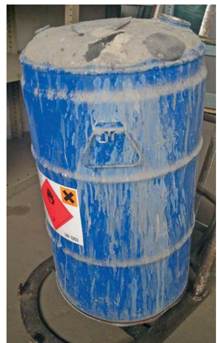
Ein 50-Liter-Abfalllösemittel-Fass: verdreht, aufgebläht, verdächtig. Was muss geschehen?
