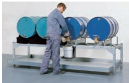
Für die Entnahme flüssiger Stoffe gibt es für nahezu alle Fasstypen passende Zapfvorrichtungen.
