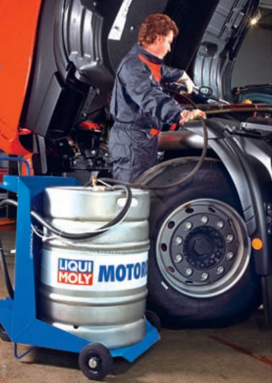
Kraftstoffe und Öle werden am sichersten in Metallfässern gelagert.
