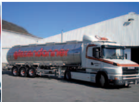
Vierkammer-Edelstahl Drucktank-Auflieger mit 35.000 Litern Fassungsvermögen von Gofa.
