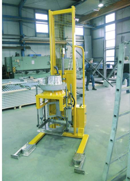
**Links: Ein pneumatischer Antrieb und die Verwendung spezieller Materialien zeichnen den Ex-Bereich-Fasheber von Schüssler aus.**
