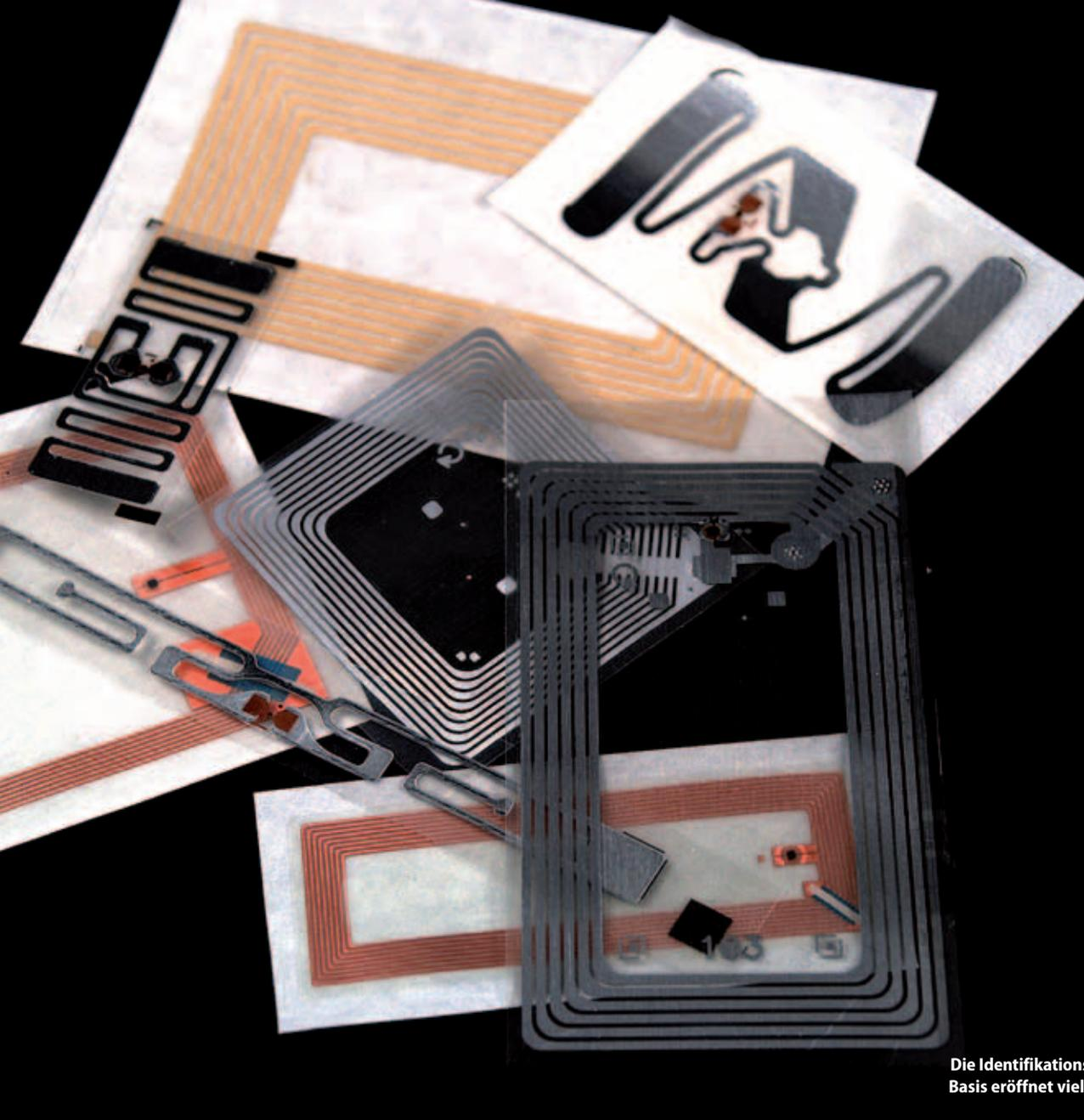
Die Identifikationstechnologie auf RFID-Basis eröffnet viele neue Möglichkeiten.
