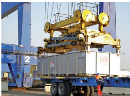
Container-Eckbeschläge an den Leckagewannen erleichtern den Transport.
