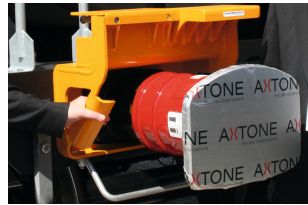
Ein Dach über dem Crashpuffer hindert andere Waggonen am Hochsteigen.
