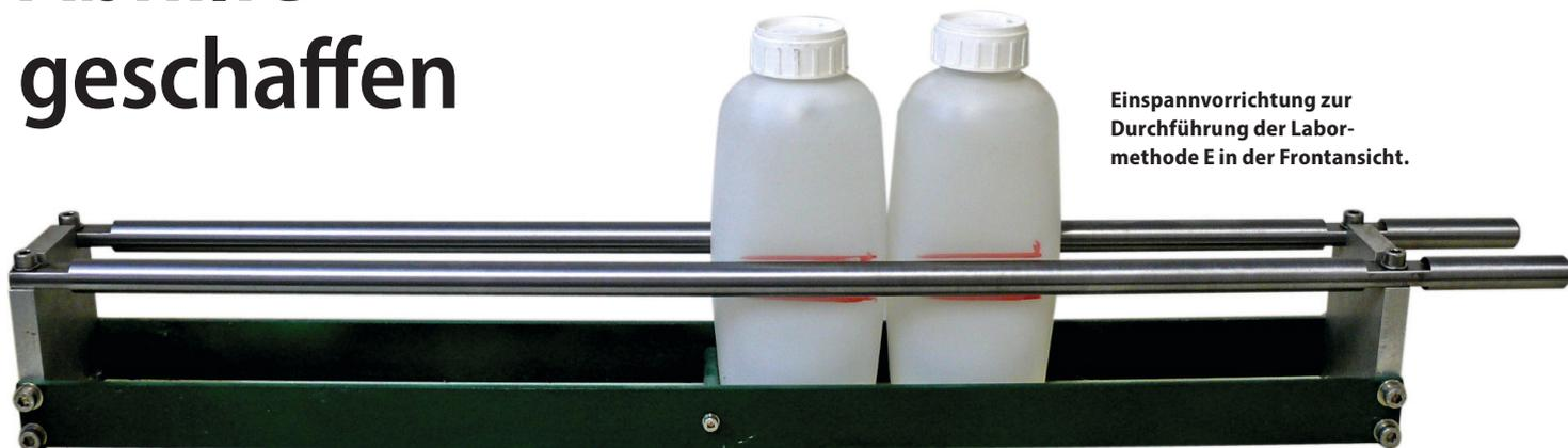
Einspannvorrichtung zur Durchführung der Labormethode E in der Frontansicht.
