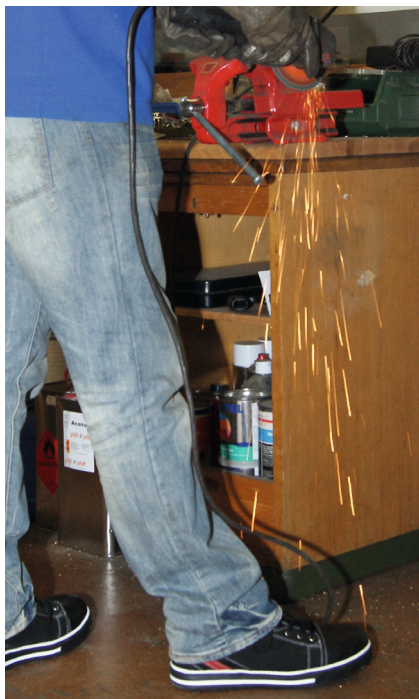
Bei Schweißarbeiten sollte das Obermaterial der Schuhe aus Leder sein.
