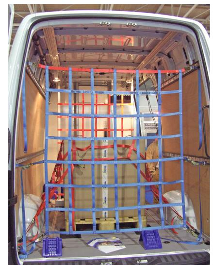
**Genähte Netze mit einer entsprechenden Maschengröße, zum Niederzurren oder auch als Trennnetz geeignet.**
