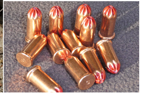
Kartuschen für Bolzensetzgeräte mit Farbkodierung für Energiestufe Rot.
