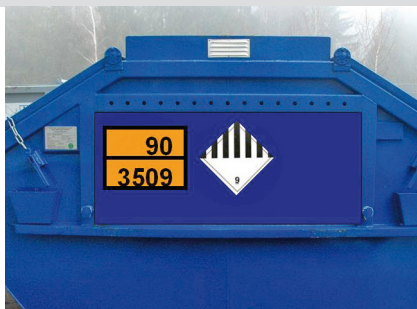
Für ungereinigte, leere Altverpackungen wird die UN-Nummer 3509 neu eingeführt, die der Klasse 9 zugeordnet ist. Damit wird der Transport leerer Verpackungen zur Entsorgung in loser Schüttung deutlich vereinfacht.
