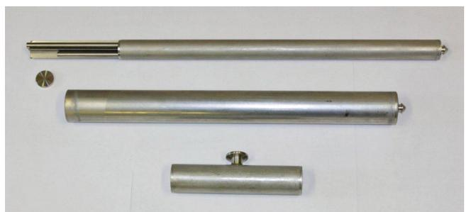
Verschiedene Bauarten radioaktiver Stoffe in besonderer Form.
