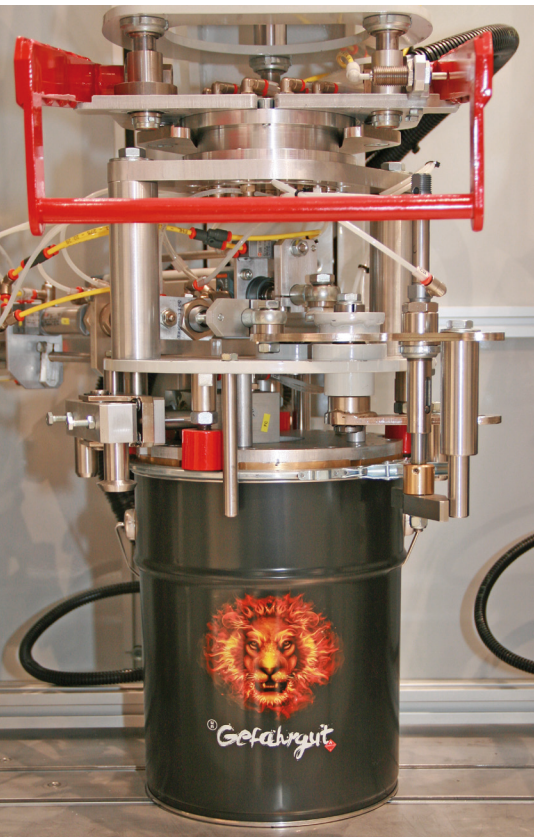
Deckel drauf, Gefahrgutlöwe dicht: Das Gerät „FlexoClose“ von Huber Packaging automatisiert das Verschließen von Weißblechverpackungen mit Spannringverschluss.
