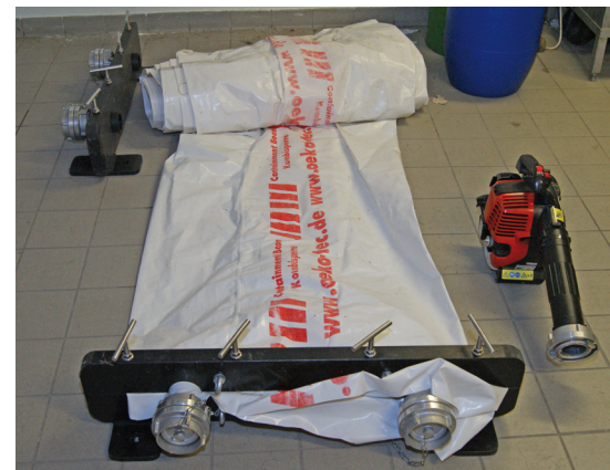
Das Doppelkammerschlauchsystem von Oeko-Tec wird gerade von der Wacker-Werkfeuerwehr getestet.
