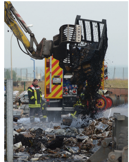
Eine einzige beschädigte Zelle/Batterie setzt einen ganzen Elektroschrotthaufen in Brand.
