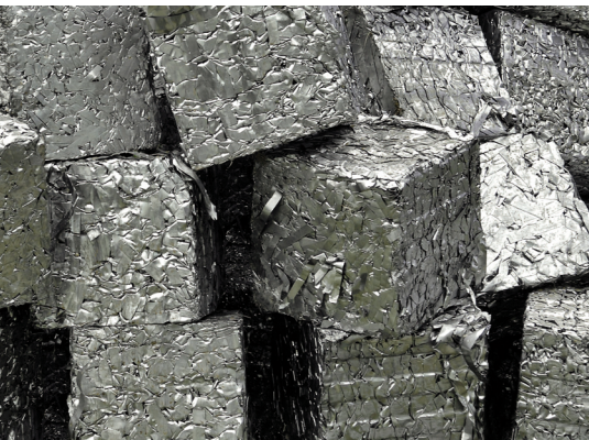
Umweltschonend: Schrottpressen verdichten Stahlschrott wie etwa gebrauchte Weißblechverpackungen zu kleinen, quaderförmigen Würfeln zur Wiederverwertung.
