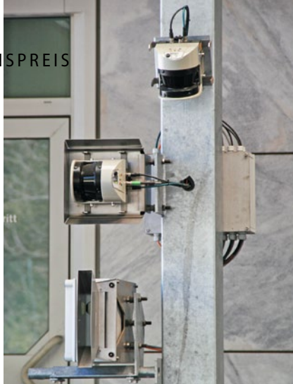
Scanner und Wärmebildkameras (re.) nehmen die Daten auf und erzeugen ein detailgenaues 3-D-Bild des Fahrzeugs. In der Praxis sind meist überhitzte Bremsen Grund für die Ausleitung.
