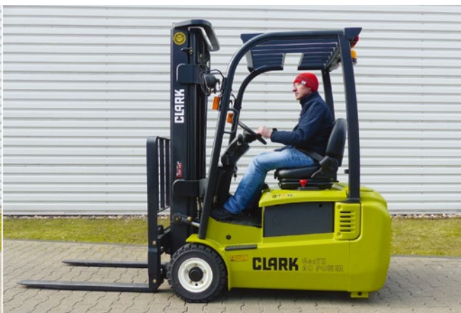
Zur Serienausstattung gehören unter anderem Arbeitsscheinwerfer, akustischer Rückfahralarm, Rückkombileuchten mit Bremslicht und Rückfahrlicht
