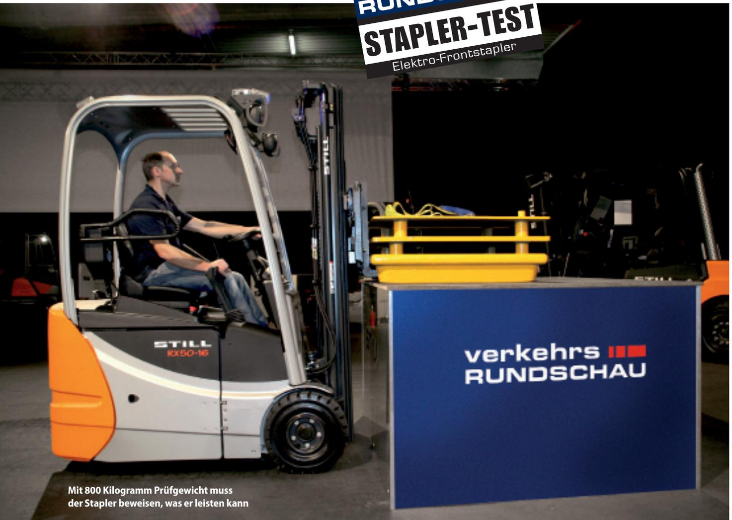
Mit 800 Kilogramm Prüfungsgewicht muss der Stapler beweisen, was er leisten kann
