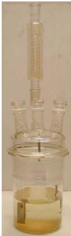
**Abbildung 37.4.2: AUSLAGERUNGSGEFÄSS MIT RÜCKFLUSSKÜHLER**
