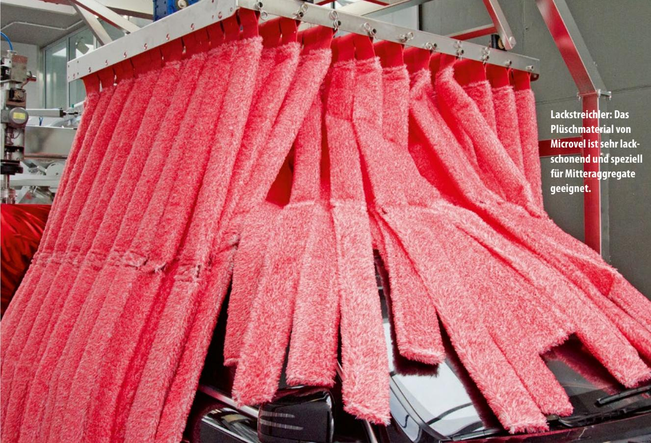
Lackstreichler: Das Plüschmaterial von Microvel ist sehr lackschonend und speziell für Mitteraggregate geeignet.
