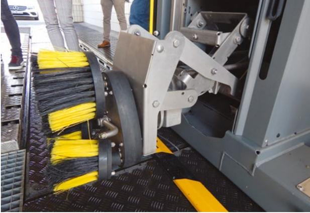
Die neue Scherenmechanik des Radwäschers führt den Bürstenteller zuverlässig zur Felgenmitte.
