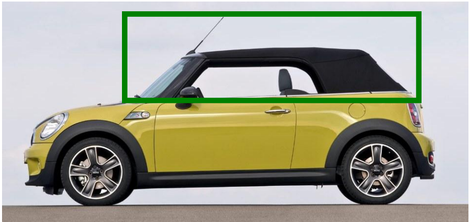
Abbildung 8: Bereich ab Fensterunterkante (Greenhouse)
