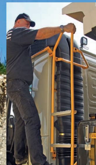
Die Stauklappe zwingt den Tritt nach hinten und den Luftfilter nach oben
