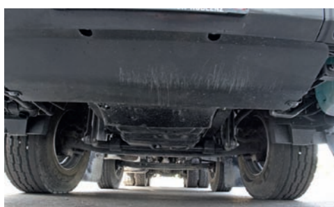
Trotz spritsparender Hypoidachsen genug Bodenfreiheit
