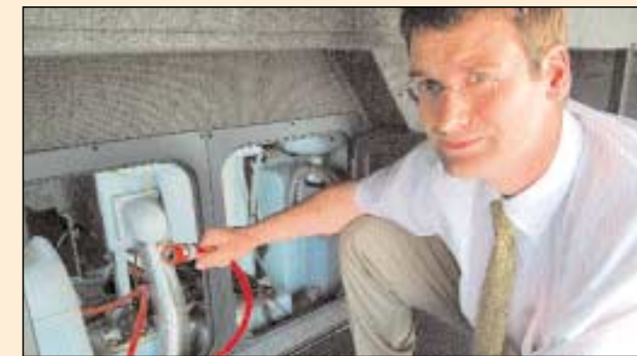
TANK 500 Liter passen in den Tank, der sich hinter der Vorderachse befindet
