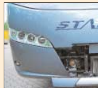
RADAR Hinter der Bugklappe steckt die Radarkeule für den Abstandsregeltempomaten
