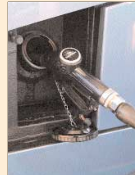
TANK 500 Liter passen in den Tank, der sich hinter der Vorderachse befindet
